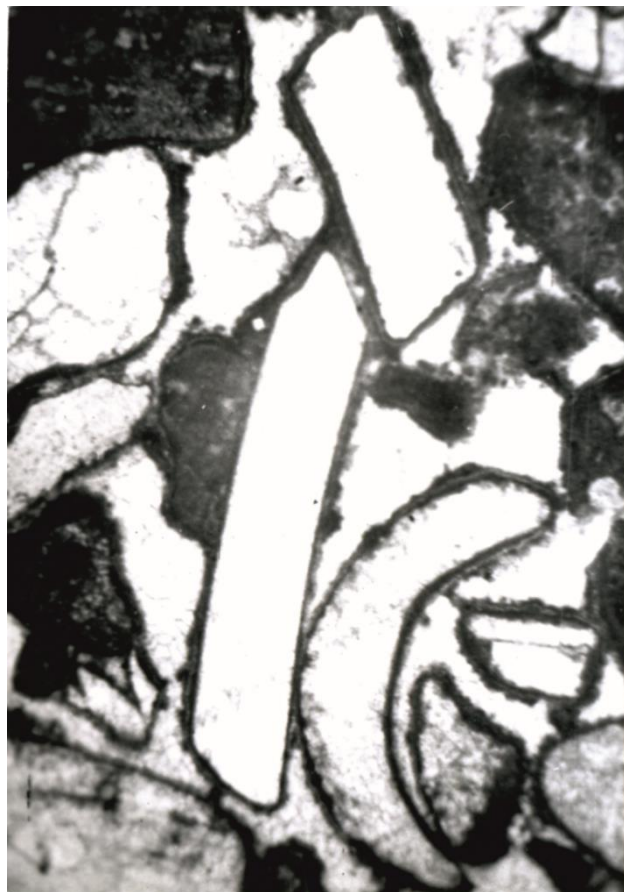
Рисунок 2.10 – Уламки призматичного шару пелеципод в уламково-полідетритовому вапняку, титон (св. Гаї-2, інт. 1932-1940 м. Нік. ||. 3б. 40)
