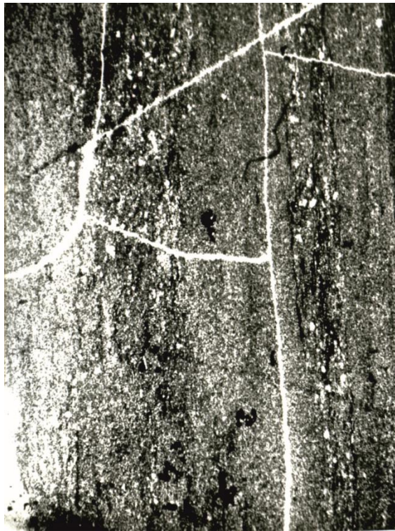
Рисунок 2.15 – Доломіт тонкозернистий з піритом у порах та мікротріщинах, кімеридж (св. Південна Гринівка -1, інт. 2547-2548 м. Нік. ||. 36.30)
